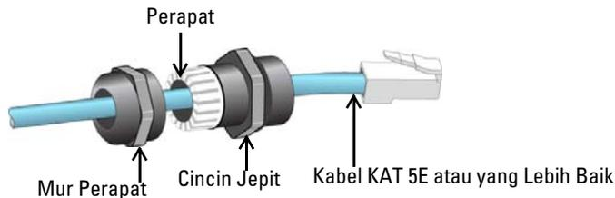
1. Masukkan kabel ke dalam mur perapat (konektor RJ45 belum terpasang).
